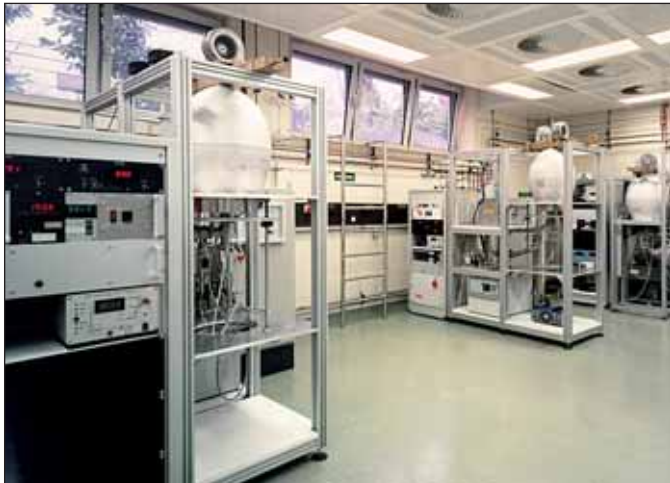
Von den Fraunhofern in Freiburg werden die Diamant-Membranen in eiförmigen Plasma-Reaktoren erzeugt und später per Laser in Form geschnitten
